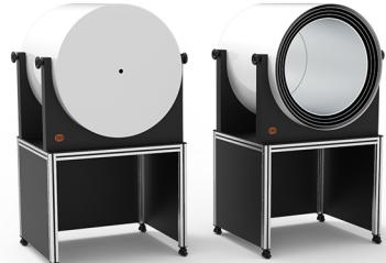
MFG-02 系列磁屏蔽筒，其内框采用多层同轴的高导磁率合金制成。在筒内中心区域具有一个较大范围可视为零磁场的环境。用于去除地磁场、环境杂散磁场的影响。适用于各研究所，高等院校及企业开展弱磁传感器 / 仪器或磁敏感元器件的相关研发与测试。
